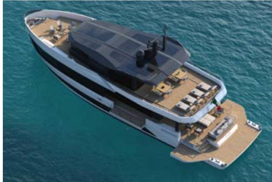
A96, 4 Volvo IPS motor ile 24 knot azami hıza ve 16 knot hızda 600 deniz mili menzile sahiptir. 10 knot hızla 2.000 deniz mili menzile ulaşır.
